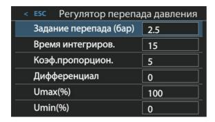
Регулятор перепада давления предназначен для управления частотными преобразователями по ПИД-закону регулирования с пропорциональным выходным сигналом за счет вычисления показаний датчиков давления.
