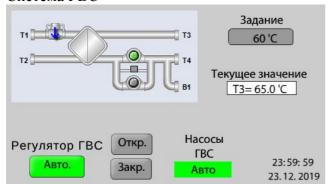
Отображение мнемосхемы, текущих параметров работы системы отопления, вентиляции, ГВС, не штатных и аварийных ситуаций.
